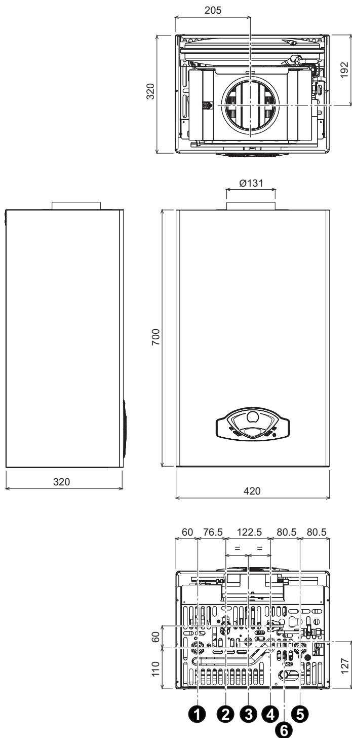
рис. 22 - Габаритные размеры и присоединения
