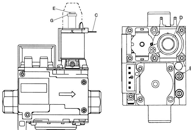
рис. 20 - Газовый клапан
