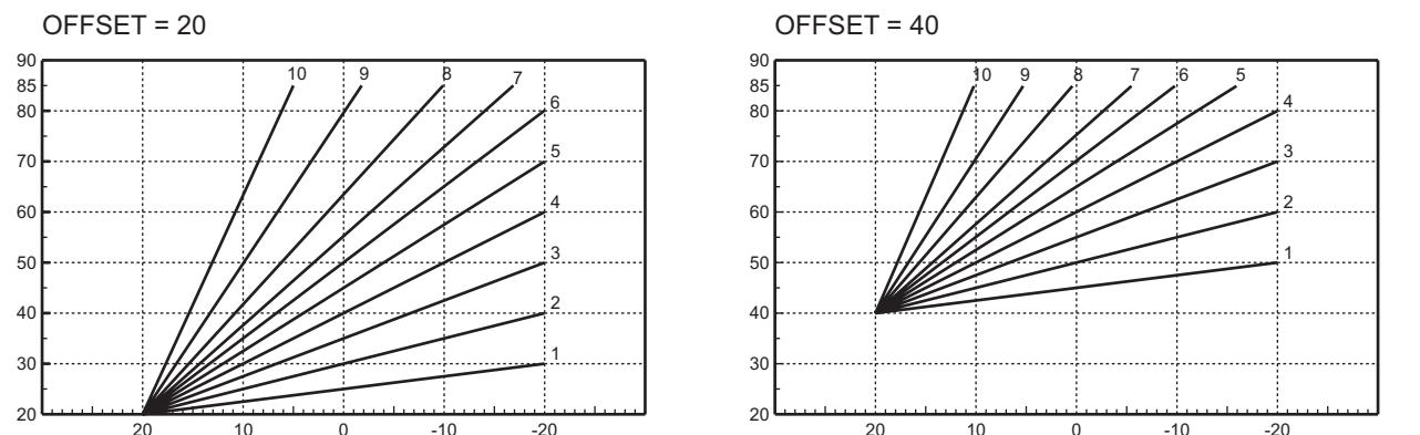
рис. 14 - Пример параллельного смещения компенсационных характеристик
