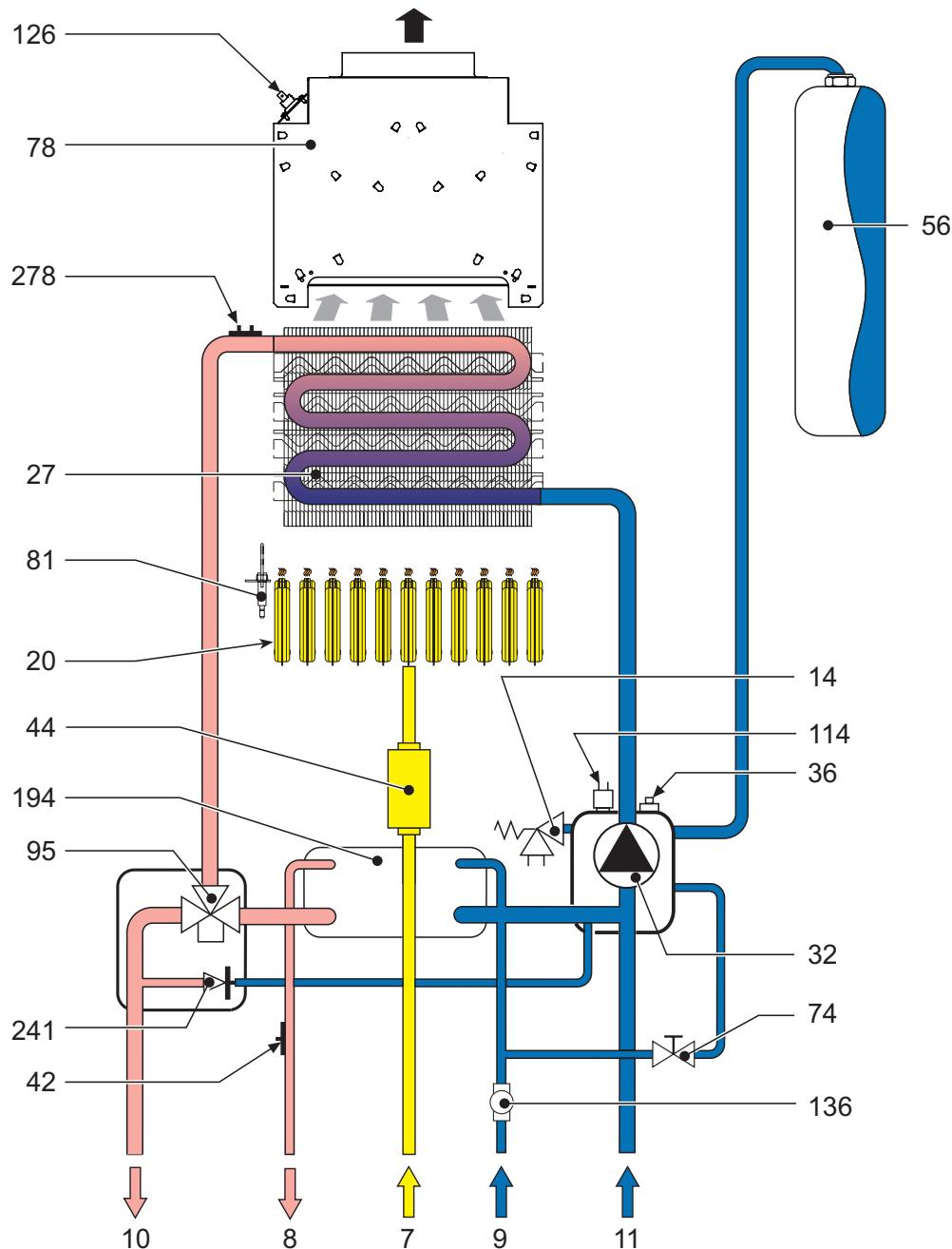
рис. 24 - Схема системы отопления и ГВС
