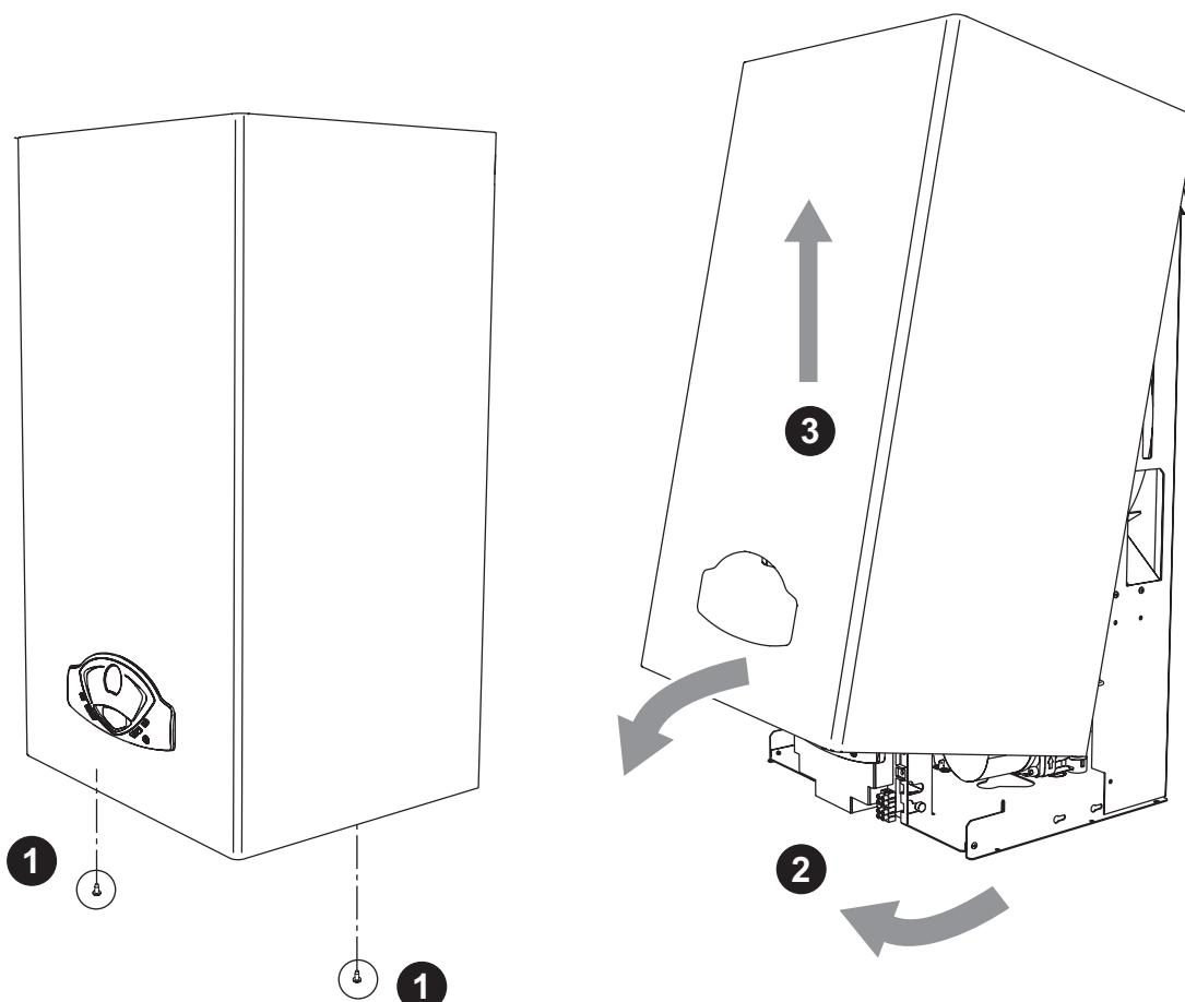
рис. 21 - Демонтаж кожуха
