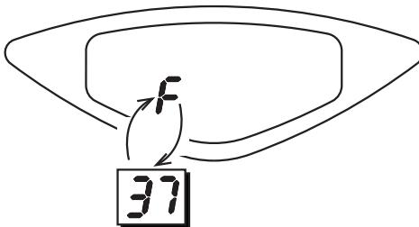
рис. 15 - Недостаточное давление воды в системе отопления
