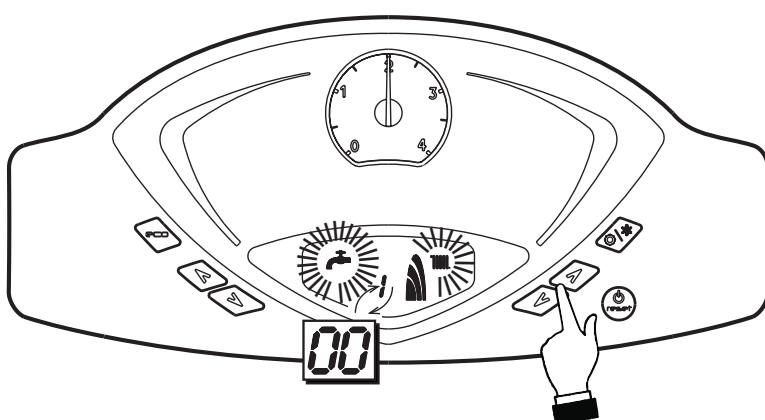
рис. 19 - Режим TEST (мощность системы отопления = 100%)
