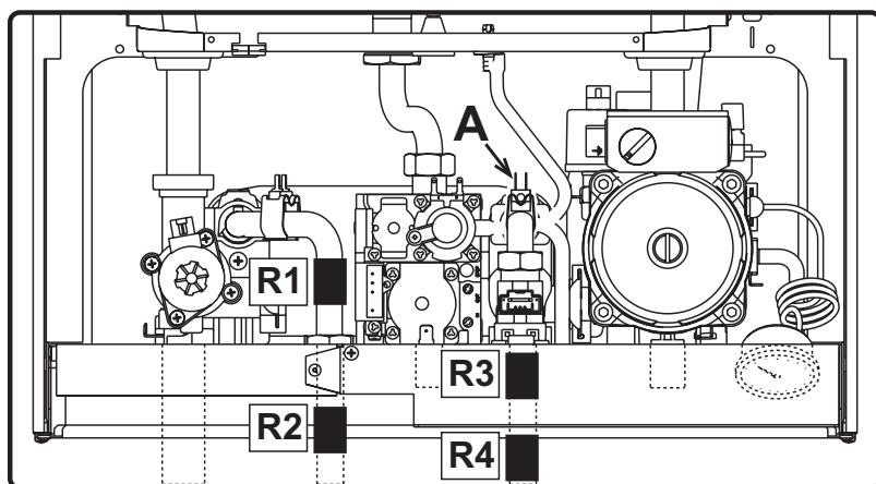
рис. 17 - Размещение нагревателей и морозозащитного термостата
